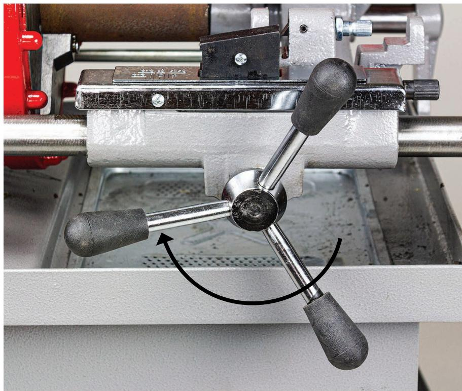
Опустите труборез на обрабатываемую деталь и включите станок выключателем. Поворачивайте рукоятку трубореза по часовой стрелке, чтобы осуществить обрезку.
