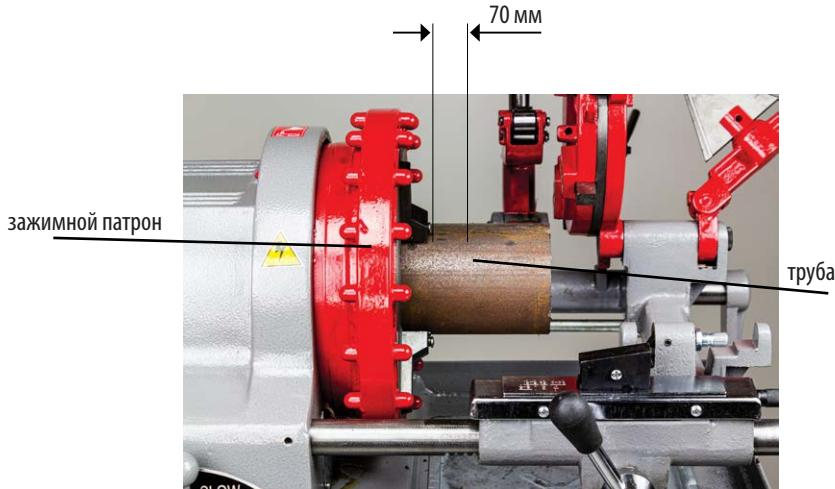
Поднимите туборез (1), резьбонарезную головку(2) и гратосниматель (3) так, чтобы они не мешали. Введите обрабатываемую деталь через центрирующий зажимной патрон (7) и затяните его.
