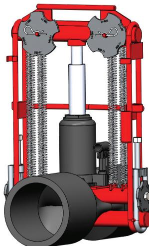
8. Продолжить передавливание трубы до момента соприкосновение обоих ограничителей **9** в нижний вал **3**.
