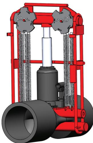
6. Закрыть клапан **5** и продолжить процесс передавливания.
