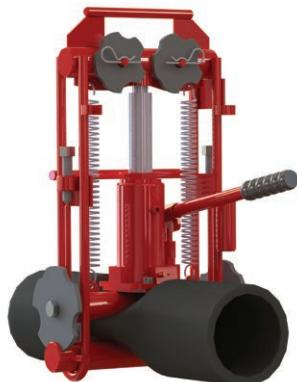
Процесс передавливания следует проводить медленно.
