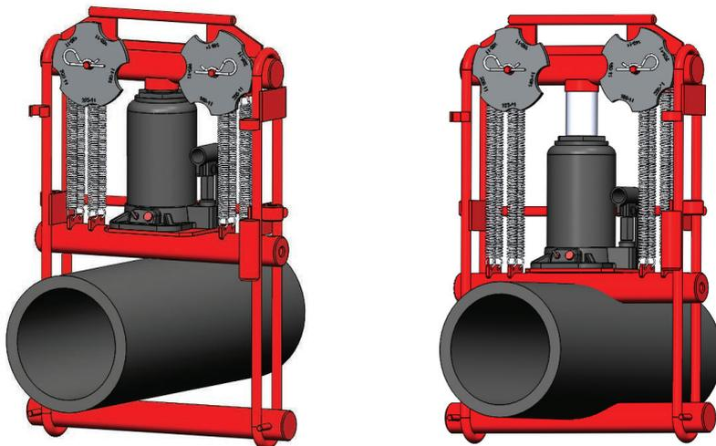
2. Выдвинуть шток **4** домкрата примерно на 8 см. (При наличии проставки выдвинуть шток примерно на 11 см).
