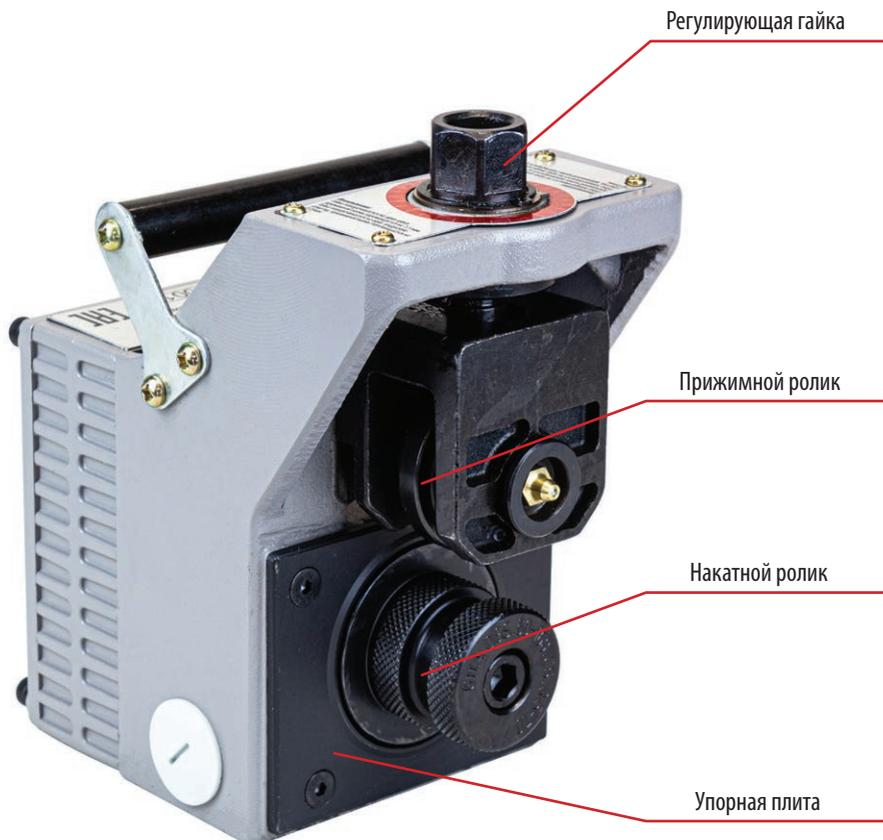
6.4 Заведите накатной ролик 3 внутрь трубы, а саму трубу уприте в упорную плиту.
