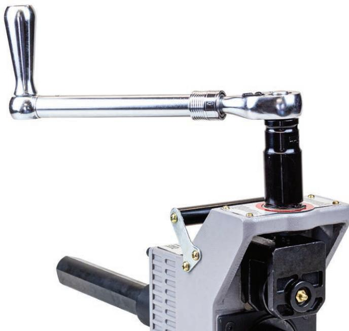
6.8 После достаточного заглубления, снимите ручку с регулирующей гайки и установите ее на приводную гайку. Вращайте ручку в любую сторону пока труба не сделает полный оборот.
