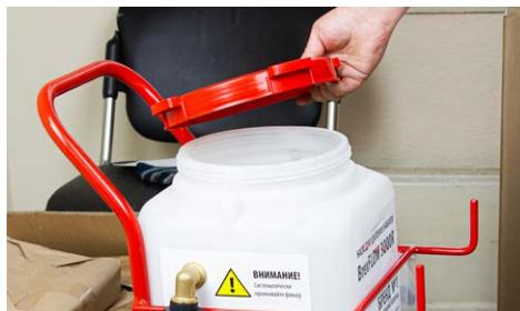
6.2.2. Откройте крышку бака, чтобы обеспечить выход воздуха.
