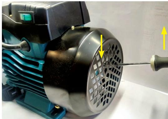
7.1.2. Расслабьте крепление корпуса крыльчатки насоса, выкрутив на 2 оборота болты крепления корпуса крыльчатки, убедитесь, что у корпуса появился небольшой люфт и сделайте пару кратковременных пусков насоса.
