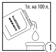
Шаг 1 - Приготовление промывочного раствора
